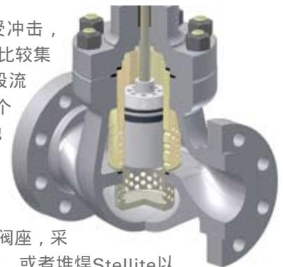
散流器的上部分为一体化阀座，采用硬质材料经过硬化处理，或者堆焊Stellite以提高抗冲刷性能。
